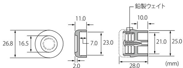
⚠️ ドライバーでキャップとネジを外してウェイトを調整してください。
