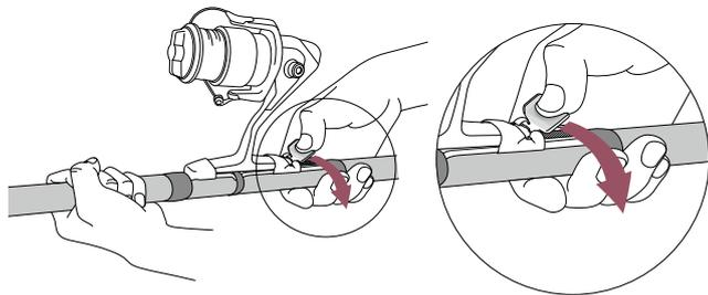
リール足およびシートの腐食を防ぐため、釣行後は必ずリールを外してから洗浄してください。砂が入り込むと不具合の原因となりますので、スライドフード部とスライド部は特によく流しましょう。
