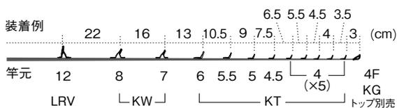
※LRVガイドを逆向きで使用すると、糸絡み自動解除機能が働かなくなるので必ず正しい向きで取り付けてください。
